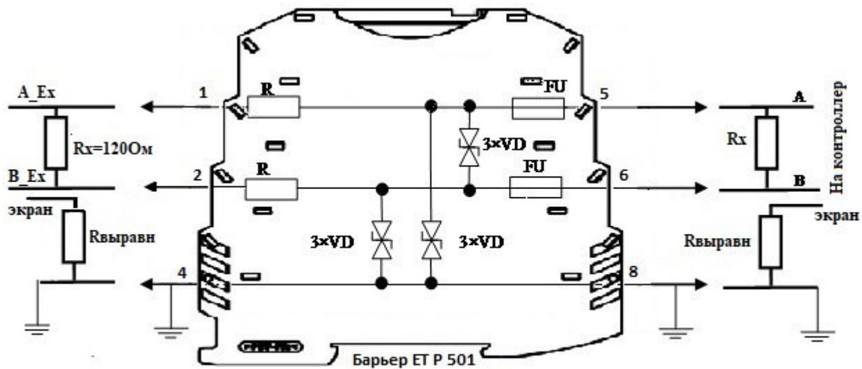
Рисунок Г.1 – Схема подключения ET P 501 к цепям интерфейса RS-485
