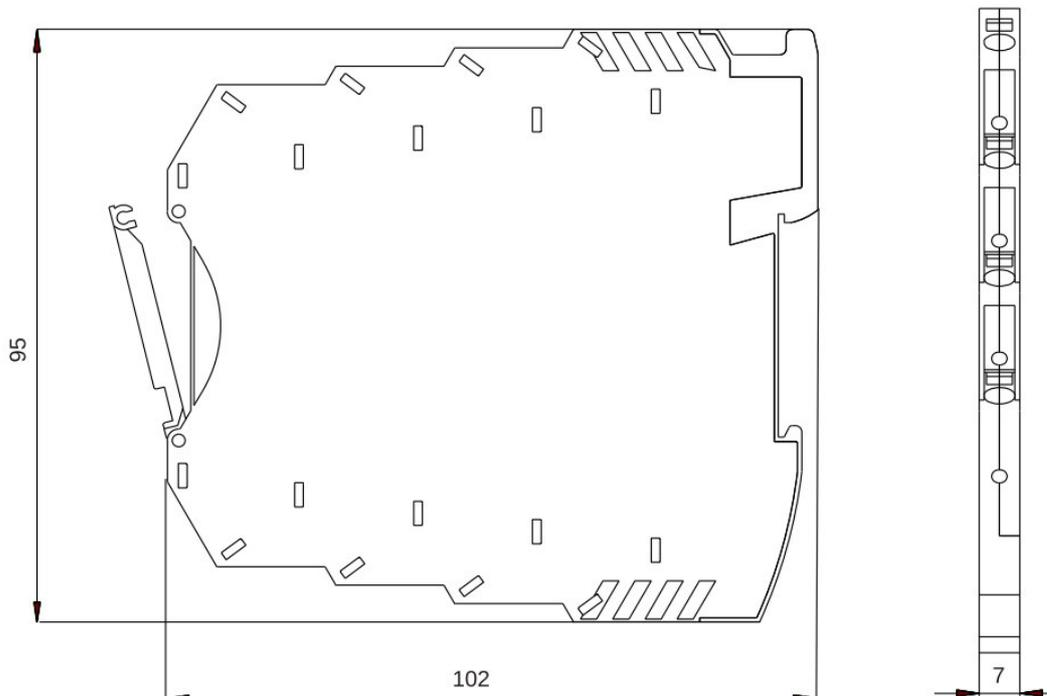
Рисунок Б.1 – Габаритный чертеж ET P 501
